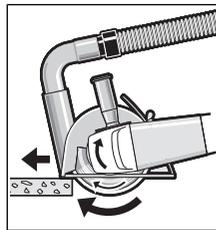
Ligue a ferramenta elétrica e coloque-a sobre a peça com a parte dianteira do patim de guia. Desloque a ferramenta elétrica com um avanço uniforme e adequado ao material a processar.
