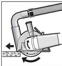
啟動本電動工具，並將其引導板前端放置到工件上。參考工件的材質，適當地施力推進機器。
