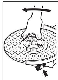
如果安装正确而且快速夹紧螺母未损坏，就可以用手逆时针方向松开滚花圆环。对于卡住快速夹紧螺母，不要用钳子而是要用双锁扳手松开。请参考插图安装双锁扳手。
