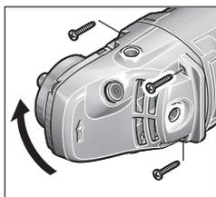
Puede girar la cabeza del engranaje en pasos de  $90^\circ$ . De este modo, el interruptor de conexión/desconexión puede situarse en una posición de manejo más adecuada para casos especiales, p. ej. para trabajos de tronzado con cubierta de aspiración con carro guía
