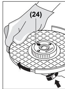
Presione la tecla de bloqueo del husillo (1), para inmovilizar el husillo amolador. Para apretar firmemente la tuerca de fijación rápida, gire el disco abrasivo con fuerza en sentido horario.
