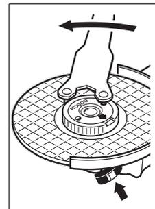
مهره مهار سریع طبق مقررات تعبیه شده و بدون عیب را می توان با چرخاندن رینگ کنگره دار در خلاف جهت عقربه های ساعت با دست باز کرد. مهره مهار سریع سفت شده را هرگز توسط یک آچار شلاق باز نکنید، بلکه از یک آچار دو سوزنه استفاده نمایید. آچار دوسوزنه را مانند تصویر قرار دهید.
