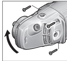
ท่านสามารถหมุนหัวเครื่องเป็นขั้นได้ขั้นละ 90° ในลักษณะนี้สวิตช์เปิด-ปิดสามารถเลื่อนไปอยู่ในตำแหน่งที่สะดวกต่อการใช้งานมากขึ้นเมื่อทำงานในสถานการณ์พิเศษ ต.ย. เช่น สำหรับงานตัดที่ใช้ผ้าครอบ
