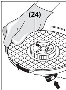
Tekan tombol penahan spindle (1) untuk menahan spindle gerinda. Untuk mengencangkan mur penjepitan cepat, putar mata gerinda searah jarum jam dengan kuat.
