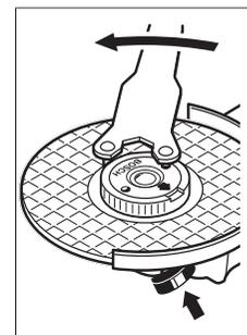
Uma porca de aperto bem fixada e sem danos pode ser desapertada manualmente rodando o anel serrilhado para a esquerda. **Nunca solte uma porca de aperto rápido presa com um alicate, utilize sempre a chave de dois furos.** Coloque a chave de dois furos como indicado na figura.
