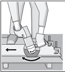
ต้องเคลื่อนเครื่องมือไฟฟ้าแบบงัดขึ้นเสมอ มิฉะนั้นจะเกิดอันตรายจากการที่เครื่องถูกผล็อกจากร่องตัดอย่างควบคุมไม่ได้ เมื่อต้องการตัดเส้นรอบนอกและทอสีเหลี่ยม ขอแนะนำให้เริ่มตรงจุดที่มีหน้าตัดที่เล็กที่สุด
