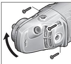
La tête de meuleuse est réglable par pas de 90°. Le fait de tourner le carter permet, lors de certaines applications, de placer l'interrupteur Marche/Arrêt dans une position plus pratique, par ex. lors de travaux de tronçonnage avec le capot de protection à glissière de
