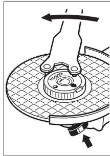
快速螺母如果安裝正確且無任何受損，您可徒手從滾花位置逆時針旋轉，以便鬆開快速螺母。如果無法用手取出快速螺母，則要使用雙鎖扳手轉鬆螺母，千萬不可以使用鉗子強行轉開螺母。請如圖所示架上雙鎖扳手。
