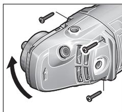
Podem rodar a cabeça do mecanismo de acionamento em passos de 90°. Dessa forma, o interruptor de ligar/desligar pode ser colocado numa posição de manuseamento mais favorável em situações de trabalho especiais, p. ex. para trabalhos de corte com
