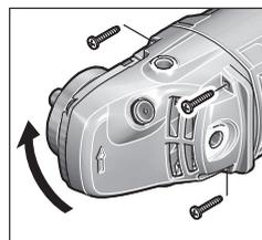
您可依照需求分段式轉動機頭，每一段的旋轉角度為 90 度。此功能的優點是能夠在特殊的工作狀況下，把起停開關移動到比較容易操作的位置，例如切割時使用具有引導板設計的吸塵罩 (21)，或是供左撇子使用。
