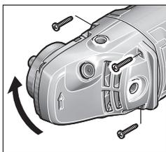
可将机头旋转90度。这样就能在特殊工作状况下将电源开关置于比较容易操作的位置，比如使用带引导滑座的切割排尘罩(21)时或针对左撇子。
