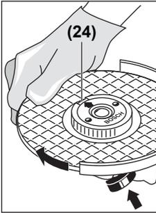
Khóa trục máy mài bằng nút khóa trục máy (1). Để siết chặt đai ốc khóa nhanh, xoay thật chặt đĩa mài theo chiều đồng hồ.
