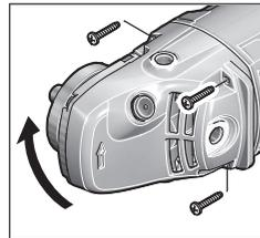
Kepala mesin dapat diputar 90° dalam setiap interval. Dengan demikian posisi tombol on/off dapat disesuaikan untuk berbagai pekerjaan khusus, misalnya untuk pekerjaan memotong dengan kap pengisap dengan unit pemandu (21) atau untuk orang kidal.
