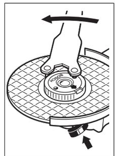
Mur penjepitan cepat yang telah dipasang dengan benar dapat dilepas menggunakan tangan dengan cara memutar cincin bergerigi ke arah yang berlawanan jarum jam. **Jangan melepaskan mur penjepitan cepat yang terpasang kuat dengan tang, melainkan gunakan kunci lubang ganda.** Pasangkan kunci lubang ganda seperti terlihat dalam
