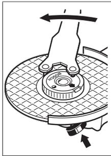
Một đai ốc khóa nhanh không bị hư hỏng, được vận chặt đúng cách, có thể dùng tay để vận lỏng ra bằng cách vận vòng vân khía ngược chiều kim đồng hồ. **Không bao giờ được tháo đai ốc khóa nhanh ra bằng kim, mà hãy dùng chìa vận hai chấu.** Tra chìa vận hai chấu vào như trong hình minh họa.
