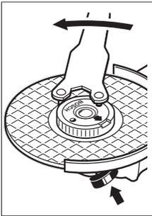
제대로 고정된 손상되지 않은 순간 교환 너트는 너트의 측면에 나있는 홈 부분을 잡고 시계 반대 방향으로 돌려서 손으로 풀 수가 있습니다. **꼭 끼워진 순간 교환 너트는 절대로 플라이어를 사용하지 말고 두핀 스패너를 사용하여 풀어야 합니다.** 두핀 스패너는 도면에 나온 대로 사용하십시오.
