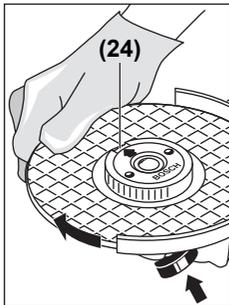
กดปุ่มล็อคแกน (1) เพื่อ ล็อคแกนเครื่อง สำหรับการขันน็อตยึดแบบขันเร็วให้แน่น ให้ไขก้านหมุนจานขัดไปในทิศทางเข็มนาฬิกา
