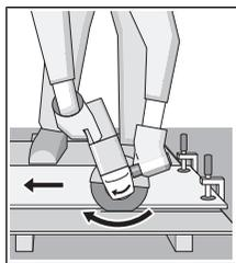
必須逆著機器的轉向推動電動工具，否則可能會因**失控**而滑出預先規劃的切線。切割具有凹凸花紋的材料及方管時，最好從橫斷面最小的位置著手。
