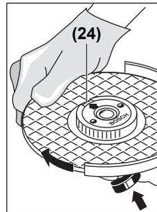
Pressione a tecla de bloqueio do veio (1), para bloquear o veio de retificação. Para apertar a porca de aperto rápido, rode o disco abrasivo para a direita com força.
