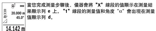
**b) 雙間接高度測量 (參考插圖 C)**
