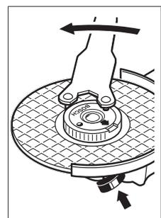
快速螺母如果安裝正確且無任何受損，您可徒手從滾花位置逆時針旋轉，以便鬆開快速螺母。如果無法用手取出快速螺母，則要使用雙鎖扳手轉鬆螺母，千萬不可以使用鉗子強行轉開螺母。請如圖所示架上雙鎖扳手。
