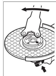
Một đai ốc khóa nhanh không bị hư hỏng, được vận chặt đúng cách, có thể dùng tay để vận lỏng ra bằng cách vận vòng vận khóa ngược chiều kim đồng hồ.
