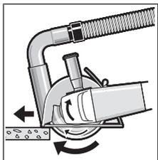
啟動本電動工具，並將其引導板前端放置到工件上。參考工件的材質，適當地施力推進機器。
