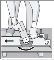
ต้องเคลื่อนเครื่องมือไฟฟ้าแบบงัดขึ้นเสมอ มิฉะนั้นจะเกิดอันตรายจากการที่เครื่องถูกผล็อกจากร่องตัดอย่างควบคุมไม่ได้ เมื่อต้องการตัดเส้นรอบนอกและทอสีเหลี่ยม ขอแนะนำให้เริ่มตรงจุดที่มีหน้าตัดที่เล็กที่สุด
