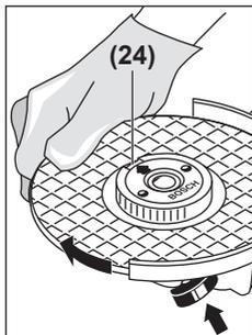
กดปุ่มล็อกแกน (1) เพื่อล็อกแกนเครื่อง สำหรับการขันนอตยึดแบบขันเร็วให้แน่น ให้ใช้กำลังหมุนจานขัดไปในทิศทางเข็มนาฬิกา
