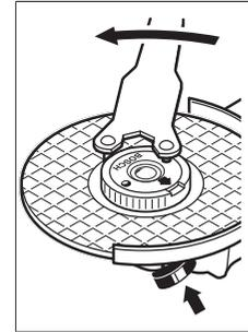
Usulüne uygun olarak takılmış ve hasarsız bir hızlı germe somununu tırtıllı halkayı saat hareket yönünün tersine çevirerek gevşetebilirsiniz. **Sıkıyan hızlı germe somununu hiçbir zaman bir pense ile gevşetmeyin, iki pimli anahtar kullanın.** İki pimli anahtar resimde görüldüğü gibi yerleştirin.
