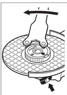
如果安装正确而且快速夹紧螺母未损坏，就可以用手逆时针方向松开滚花圆环。对于卡住的快速夹紧螺母，**不要用钳子而是要用双销扳手松开**。请参考插图安装双销扳手。
