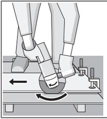
Máy luôn luôn phải được vận hành theo chuyển động mài ở tư thế thẳng đứng. Nếu không như vậy, có nguy cơ bị đẩy mà không điều khiển được máy ra khỏi mạch cắt. Khi cắt một thanh vật liệu có mặt nghiêng và góc vuông,
