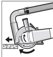
Mettez en marche l'outil électroportatif et posez-le sur la pièce avec la partie avant de la glissière de guidage. Déplacez l'outil électroportatif sur la pièce avec une vitesse d'avance modérée, adaptée au type de matériau.
