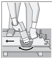
必須逆著機器的轉向推動電動工具，否則可能會因其失控而滑出預先規劃的切線。切割具有凹凸花紋的材料及方管時，最好從橫斷面最小的位置著手。
