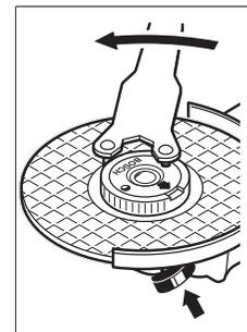
Mur penjepitan cepat yang telah dipasang dengan benar dapat dilepas menggunakan tangan dengan cara memutar dengan cara memutar cincin bergerigi ke arah yang berlawanan jarum jam. **Jangan melepaskan mur penjepitan cepat yang terpasang kuat dengan tang, melainkan gunakan kunci lubang ganda.** Pasangkan kunci lubang ganda seperti terlihat dalam
