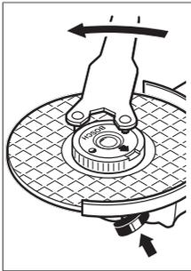
Uma porca de aperto bem fixada e sem danos pode ser desapertada manualmente rodando o anel serrilhado para a esquerda. **Nunca solte uma porca de aperto rápido presa com um alicate, utilize sempre a chave de dois furos.** Coloque a chave de dois furos como indicado na figura.
