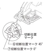
製品の寸法が短くならないよう、切り欠きを切断線に合わせて、切断してく
